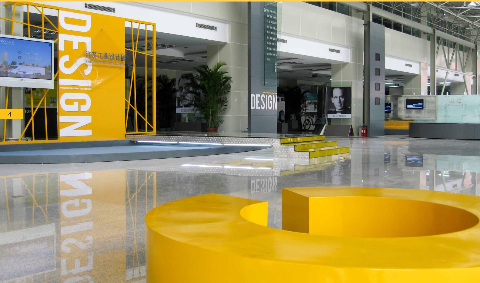
江苏省工业设计园展示设计以工业的视觉语言强调展示设计的符号感。整体空间布局强调灵活、流畅，与本身场地的方正形成对比。展架利用圆钢+驳接爪的构造方式，新颖、独特。圆钢的顶端斜向削切，不锈钢的驳接爪与金属扣，这些都构成了富有工业感的细节设计。
